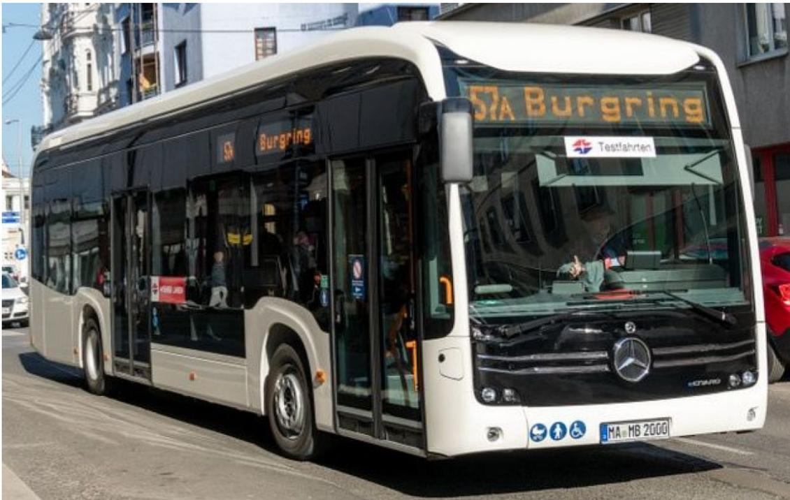
**Bild 4:** Mercedes eCitaro; Normalbus 12 m, Li-ion-Flüssigbatterie, damit zwar mit ca. 170 km pro Ladung geringere Kapazität, aber Flashcharging möglich (1 Schnelladestation im Linienweg).
