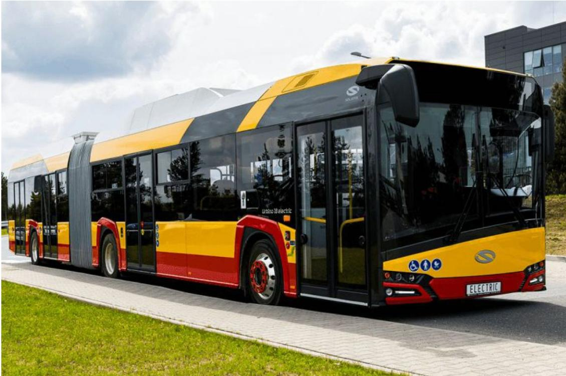
**Bild 3:** Solaris Urbino 18 electric; Gelenkbus mit 18 m (Bild), Feststoffbatterie, auch als Dreiachser mit 15 m. Reichweite 200 km pro Ladung, Ladedauer 5 h, somit nur geeignet für Overnight-Charging.
