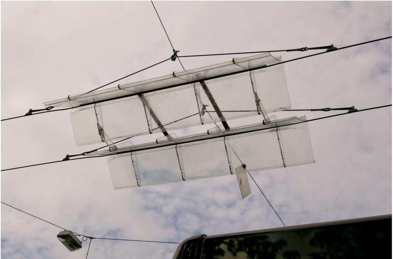
**Bild 9:** Eindrahtungstrichter zum schnellen automatischen Eindrahten nach fahrleitungslosen Abschnitten
