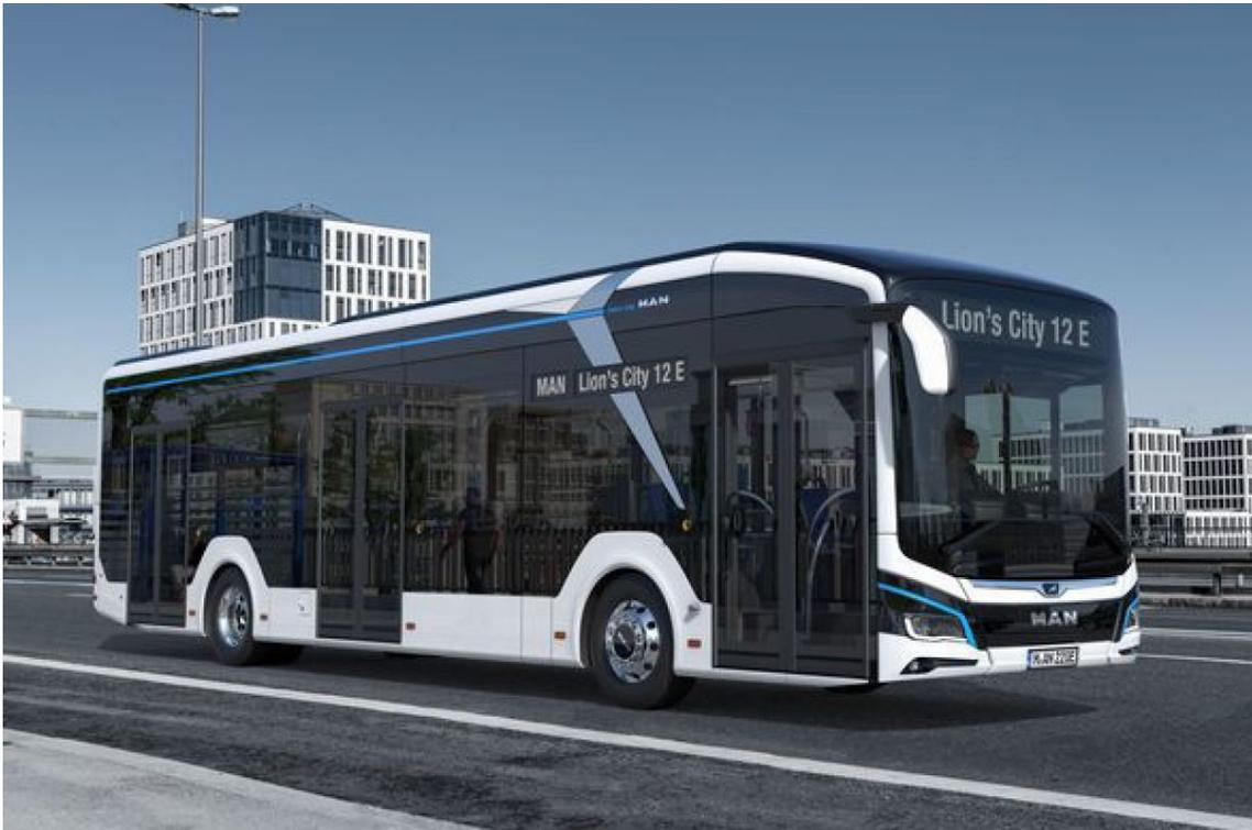
**Bild 1:** MAN Lion's City 12 E; Feststoffbatterie, Reichweite 200–270 km pro Ladung, Ladedauer <3 h. Feststoffbatteriemodule auswechselbar im Fall von Technologie-Upgrade.
