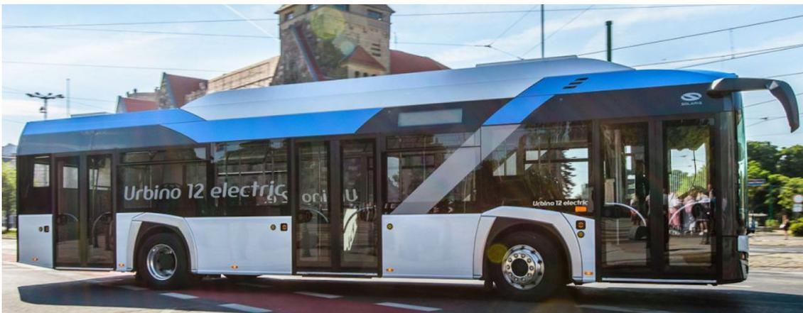
**Bild 6:** Solaris Urbino 12 electric; Li-ion-Flüssigbatterie, Normalbus 12 m, auch als Midibus 8,9 m, Flashcharger, Reichweite 150 km pro Ladung.
