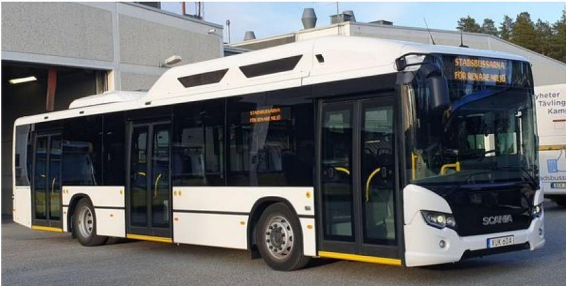
**Bild 5:** Scania Citywide BEV; Normalbus 12 m, Li-ion-Flüssigbatterie, Flashcharger, Reichweite nur 100 km pro Ladung, aber von VUs und Fachmagazinen hervorragend bewertet ("zuverlässig wie ein Dieselbus").
