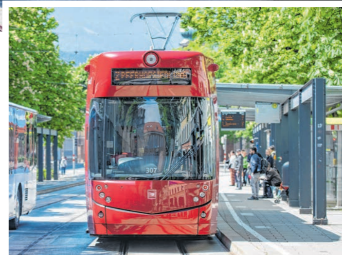
Die Haltestelle Terminal/Marktplatz ist eine sogenannte Doppelhaltestelle, an der mehrere Fahrzeuge hintereinander Platz haben.
