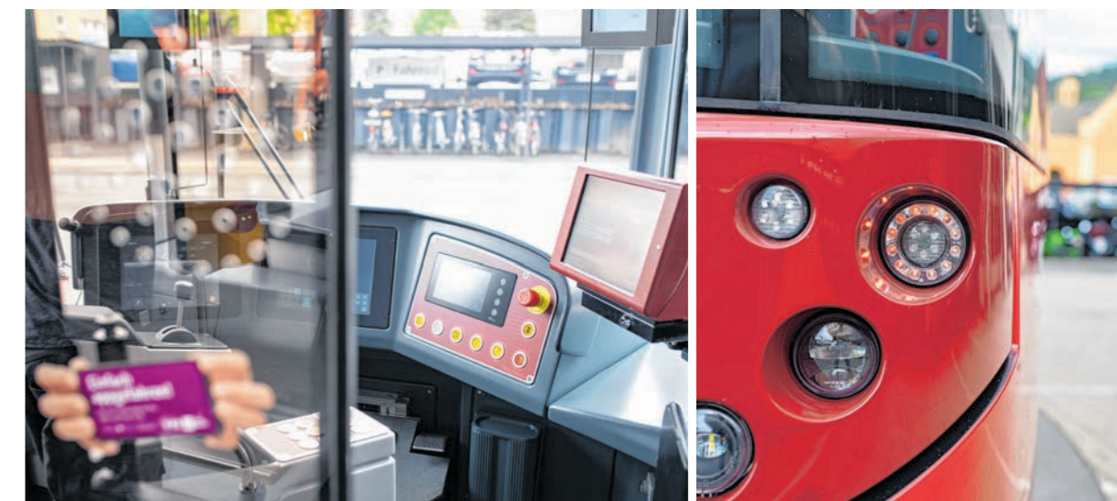
Die Sitzplätze in den FahrerInnenkabinen sind ergonomisch gestaltet, beleuchtet sind die Trams – innen wie außen – mit LED-Lampen.
